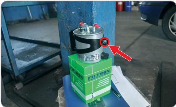
**PL** Ze zużytego filtra zdemontuj obejmę i zainstaluj ją na nowym filtrze
