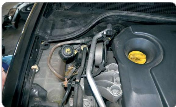
**PL** Pompuj pompką ręczną, aż do wyczucia oporu, uruchom silnik, sprawdź szczelność układu
