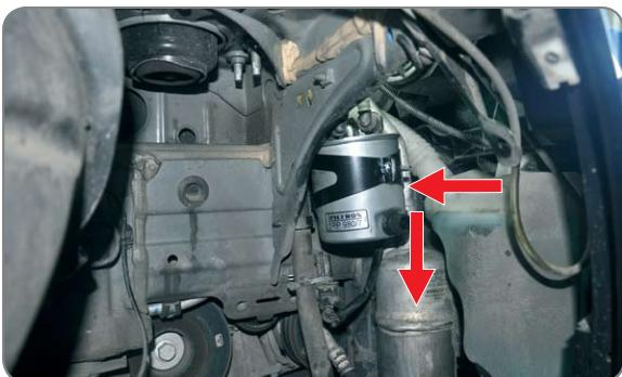
**PL** Zamontuj element zaworu podgrzewacza paliwa, wąż paliwa a następnie umieść filtr w gnieździe
