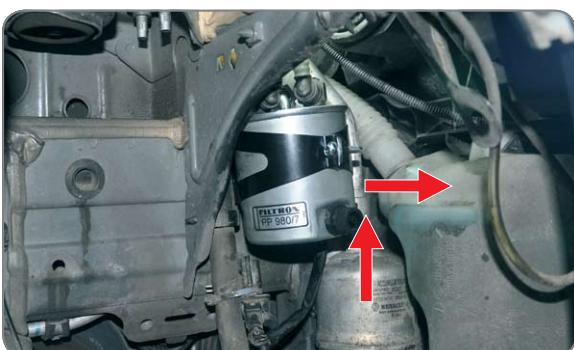
**PL** Zdemontuj filtr, rozepnij szybkozłączki i element zaworu podgrzewacza paliwa
